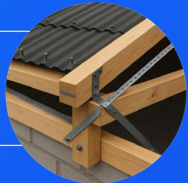
**Coberturas ancoradas, fixadas com parafusos estruturais, fitas metálicas contínuas e contraventamento.**
